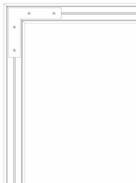
12. במקרה ומתוכננת זווית בתעלה, יש להתחיל את ההתקנה ממנה. יש לוודא שהפתח בגבס חתוך ברוחב הנכון (תמונה 1). יש לוודא שהפתח בגבס חתוך בזווית של 90 מעלות. יש להרכיב את פרופילי הזווית ולוודא הצמדה מלאה ביניהם. יש לוודא הצמדה מלאה בין שולי הפרופילים לגבס, ושאינן הבדלי גובה בשוליים. יש לחבר הזווית המתכתית לצורך פילוס הפרופילים לפי תמונה זו.
