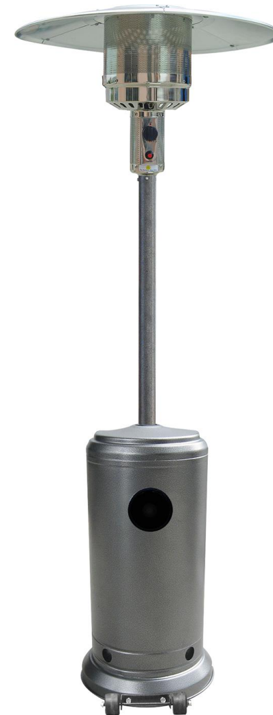
פטריית גז איכותית עשויה ברזל / מק"ט – HSS-A גובה – 244 ס"מ. רוחב כיפה עליונה – 81 ס"מ. רוחב הבסיס – 44 ס"מ. הספק מקסימאלי - 44,000 BTU צריכת גז לשעה - 450 – 870 גרם/שעה.
